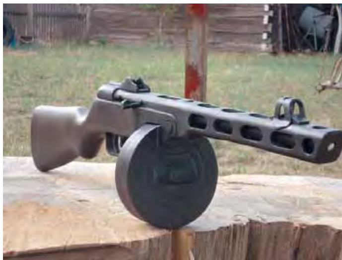
ՊՊՇ-41 ատրճանակ-գնդացի: Արտադրության համար գրավիչ էր ՊՊՇ-41-ի կառուցվածքային պարզությունը, իսկ զինվորների կողմից սիրվեց առաջին հերթին բարձր արագաձգության համար:
