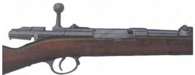
Մաուզերի 1898թ. օրինակի հրացանի հարվածաձգանային մեխանիզմը՝ փակադակը բաց դիրքում:
