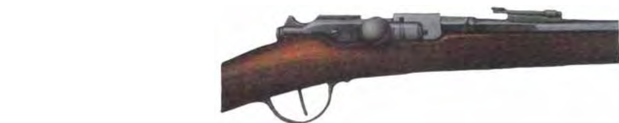
1874թ. արտադրության Գրայի հրացանի կենտրոնական մասը (հարվածածագանային մեխանիզմը, փակադակը և նշանոցը)։
