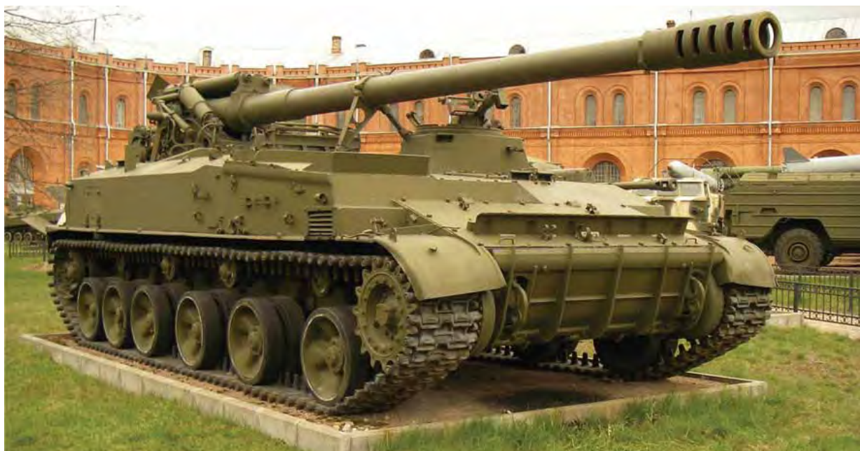
152 մմ տրամաչափի 2Մ5 «Գիացինտ» ինքնազնաց թնդանոթն Արցախյան զոյամարտի ընթացքում կիրառված ամենահեռահար հրետանային միջոցն է եղել:
